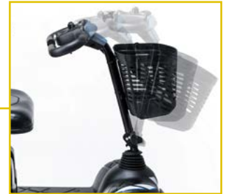
Columna de conducción
